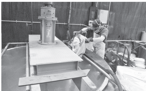
鞣しに使用するミモザのパウダーを投入
