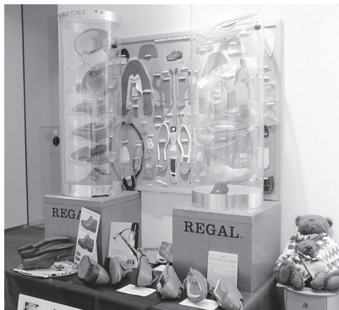
グッドイヤー製法の靴を分解して見せる
